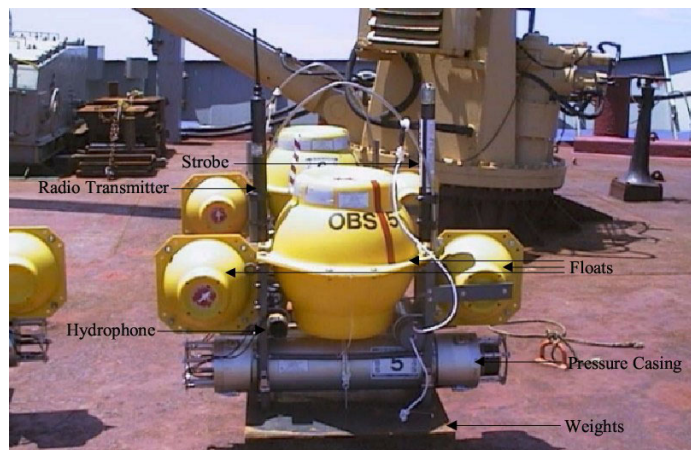
FIG. 3. Ocean bottom seismometer. (Dalhousie Seismic Group, 2002)
