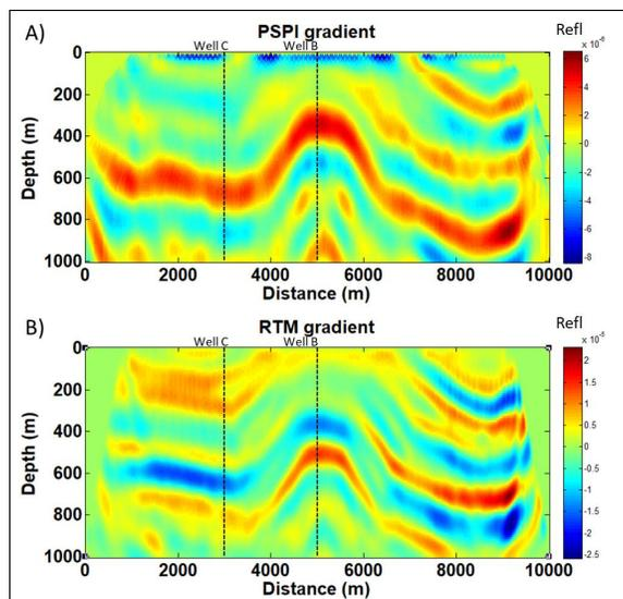
FIG. 8. A) PSPI gradient. B) RTM gradient.
