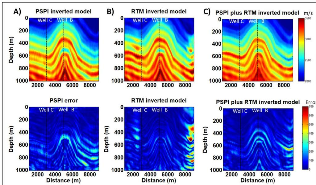
FIG. 14. A) PSPI final inversion. B) RTM final inversion. C) RTM plus PSPI final inversion
